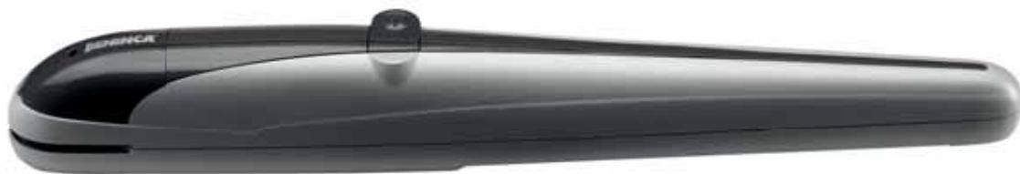
Motorreductor fiable, silencioso y rápido de instalar, gracias a los 2 topes mecánicos regulables en apertura y cierre. Disponible en las versiones 230 Vac y 24 Vdc. Tornillo mecanizado de sección esférica Ø 20 mm. Desbloqueo por arriba, de fácil acceso.
